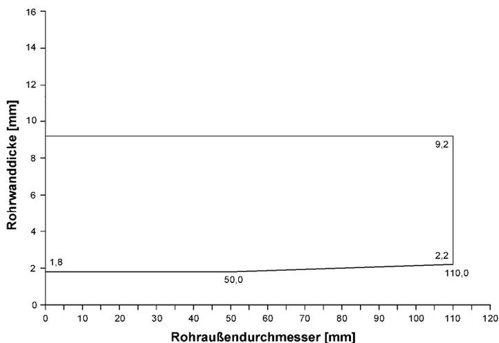
Rohre der Rohrgruppe B nach Anhang 1: PE-HD, PE-LD,
