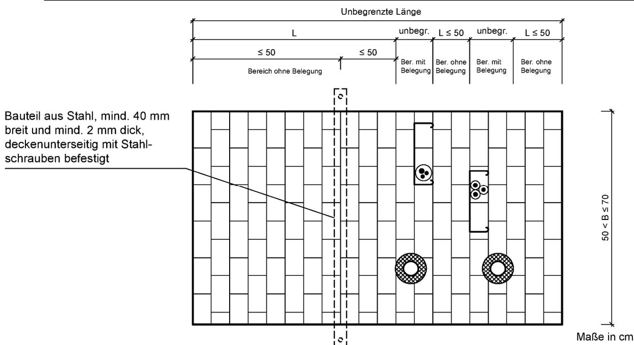
Bei Einbau in Öffnungen in Massivdecken (s. Anlagen 14 bis 17), mit Breiten  $50 \text{ cm} < B \leq 70 \text{ cm}$ , muss in Abschottungen ohne Belegung bzw. in Bereichen ohne Belegung mit einer Länge über 50 cm eine der dargestellten Maßnahmen erfolgen (vergl. Abschnitt 2.5.2.4.6)
