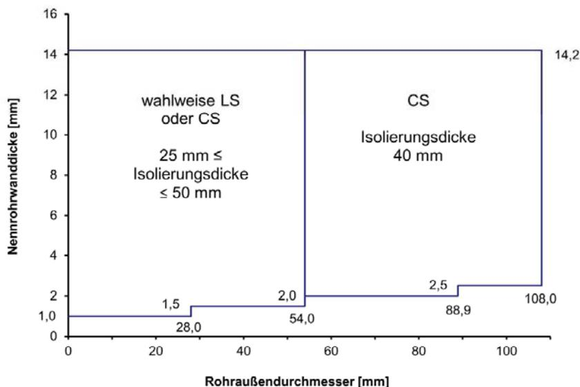
\* Foamglas, Deutsche Foamglas GmbH, Verklebung der Rohrschalen mit Kleber PC 18 und Sicherung durch zwei Spannbänder je Seite in 10 cm bzw. 40 cm Abstand zur Schottoberfläche
