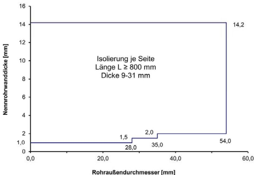
Die Rohrinsolierung/Streckeninsolierung darf wahlweise durch die Abschottung hindurchgeführt werden oder beidseitig an die Schottoberflächen angrenzen. Die Isolierungen sind gemäß Herstellerangaben an den Stoß- und Längsfugen zu verkleben (u.a. mit selbstklebenden Streifen aus flexiblem Elastomerschaum mit einer Breite  $\geq 50$  mm und einer Dicke von ca. 3 mm).
