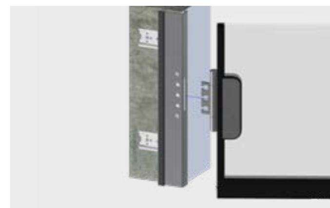
Türflügel einhängen und einstellen (4. und 5.)
