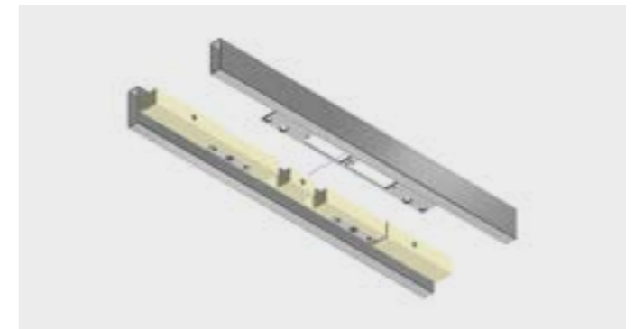
Über die angezeigten Schrauben können das bandseitige und bandgegenseitige Profil der Rohrrahmenzarge getrennt werden.
