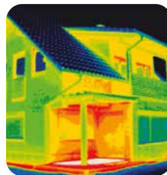
Slika prikazuje pogled s termovizijsko kamero, ki nam pomaga poiskati in oceniti toplotne izgube na objektu.
