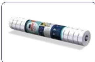
**MEMBRANA ESTANCA AL AIRE CON VALOR SD FIJA** Barrera de vapor con estanqueidad al aire, de polipropileno, de 0,3 mm de espesor y 100 g/m<sup>2</sup>, de Sd fija de 25 m espesor de aire equivalente frente a la difusión de vapor de agua, según UNE EN 1931, permeabilidad al aire 0,02 m<sup>3</sup>/h·m<sup>2</sup> a 50 Pa, (Euroclase E de reacción al fuego según UNE EN 13501-1), rango de temperatura de trabajo de -40 a 80°C, suministrada en rollos de 1,50x25 m, según UNE EN 13984.
