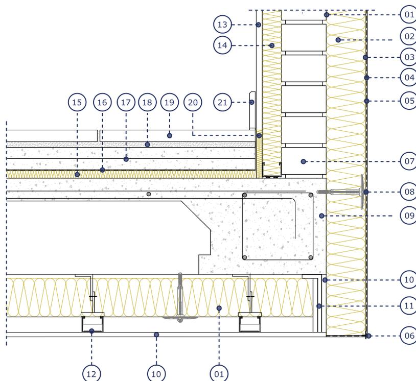
01. Mortero adhesivo para fijación química de paneles XPS.
