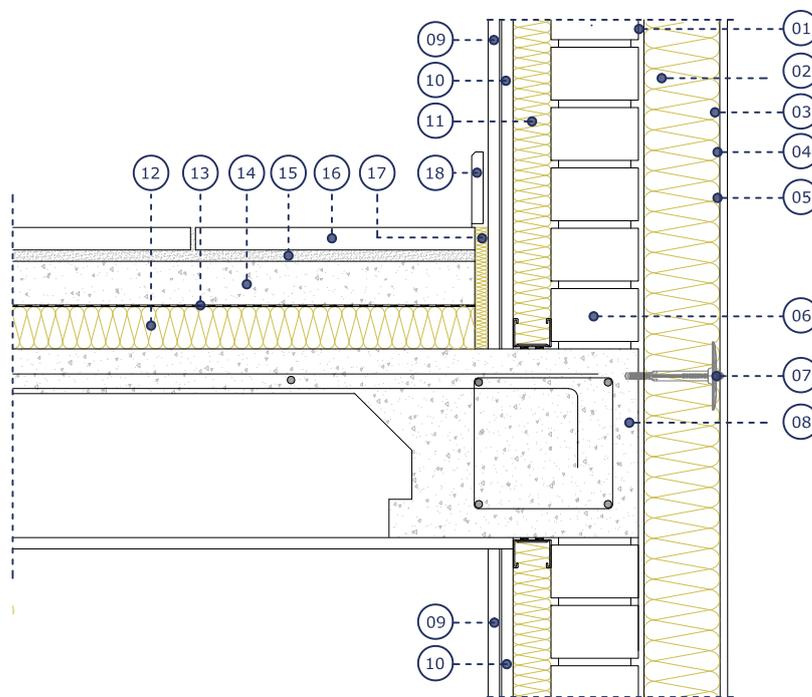
01. Mortero adhesivo para fijación química de paneles XPS.
