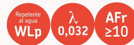
Panel semirrígido de lana mineral **URSA TERRA** conforme a la norma UNE EN 13162, no hidrófila, de altas prestaciones mecánicas, sin revestimiento. Suministrado en panel y panel enrollado.
