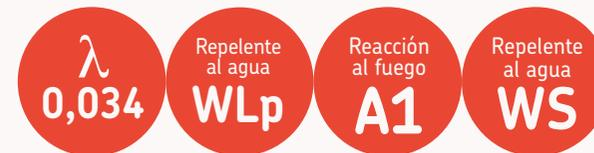
Panel semirrígido de lana mineral **URSA TERRA** conforme a la norma UNE EN 13162, no hidrófila, recubierto con un velo negro. Suministrado en panel.
