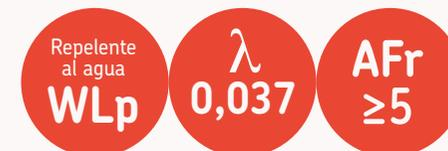
Panel de lana mineral URSA TERRA conforme a la norma UNE EN 13162, no hidrófila, sin revestimiento. Suministrado en panel y panel enrollado.
