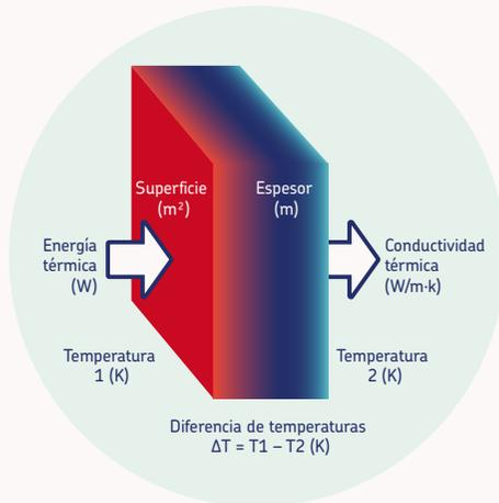
$$\text{Conductividad térmica (W/m·K)} = \frac{[\text{Energía Térmica (W)} \cdot \text{Espesor (m)}]}{[\text{Diferencia de Temperaturas } \Delta T \text{ (K)} \cdot \text{Superficie (m}^2\text{)}]}$$
