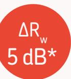
\* Ensayo de mejora aislamiento acústico al ruido aéreo de fábrica de ladrillo doble aislado con cámara de aire rellena de URSA PUREONE Pure Floc KD según UNE-EN ISO 10140-2:2011 y UNE-EN ISO 10140-1:2016 (Anexo G).
