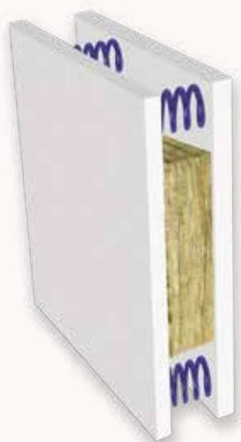
Los sistemas de placa de yeso laminado funcionan acústicamente bajo el principio masa-muelle-masa. La eficacia de estos sistemas se fundamenta en la elasticidad de las lanas minerales.
