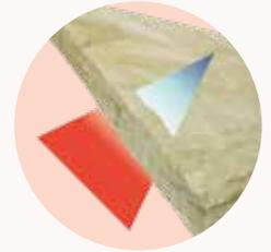
Los gases son muy malos conductores al paso del calor, por tanto muy buenos como aislantes térmicos. Gracias a la porosidad abierta, la lana mineral de vidrio permite que el aire quede ocluido en el interior de sus poros, llegando a conductividades térmicas cercanas a la de los gases. Debido al adecuado tamaño de los poros se evita al máximo la transmisión de calor por convección, radiación y conducción.
