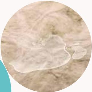
En los ensayos de absorción de agua por inmersión parcial a corto plazo, la clasificación WS en el marcado CE del producto equivale a una absorción de menos de  $1 \text{ kg/m}^2$  de absorción de agua en inmersión parcial durante 24 horas
