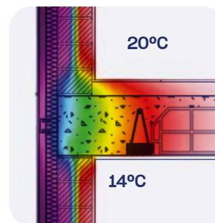
En el gráfico se ha realizado la simulación de una termografía, y se puede observar la pérdida de confort térmico que tenemos en el frente de forjado.
