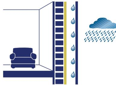
La lana mineral **URSA TERRA**, por su estructura y proceso de fabricación, es repelente al agua (hidrofóbica o no hidrófila) por lo que no capta humedad ni la transmite a otras capas del cerramiento.
