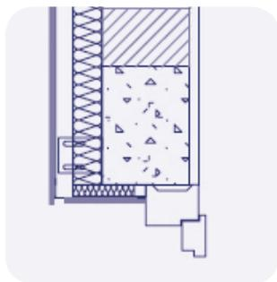
Es totalmente desaconsejable colocar la carpintería por delante del aislante (en el plano del revestimiento) ya que imposibilita la ventilación de la cámara e impide el drenaje de la misma. No debe olvidarse la entrada de aire y drenaje de eventuales infiltraciones de por lo menos 20 mm de anchura.
