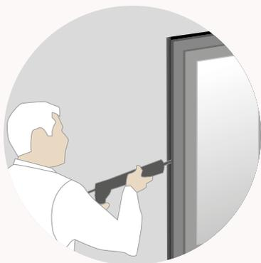
1. **Aplicar la masilla** de cola sobre el contorno de la carpintería (por la parte interior) formando un cordón de unos 8 mm aproximadamente, regular y continuo para evitar toda entrada de aire, en los 4 lados de la carpintería (o en los 3 lados en el caso de una puerta o de un balcón).
