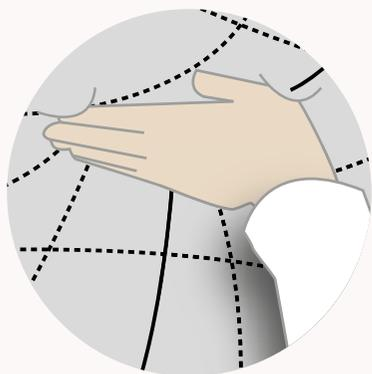
1. **Dejar 5 cm de distancia** como mínimo entre todos los puntos de la membrana y la superficie estanca (comprobación mediante simple presión de la mano sobre la membrana).
