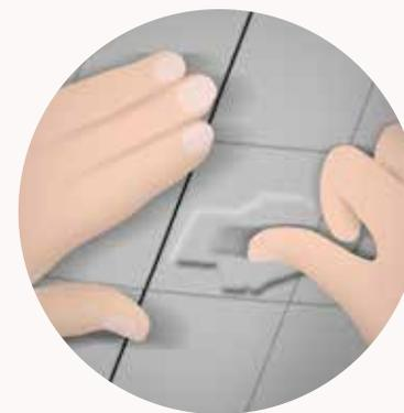
4. A través de la membrana, marcar la posición de la suspensión con ayuda del pulgar.
