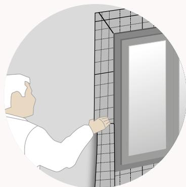
2. **Colocar las tiras de la membrana** en cada uno de los 3 o 4 lados de la carpintería después de haberlas recortado previamente de 20 cm de anchura máxima (formato A4).
