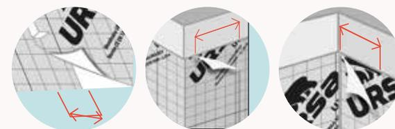
Para una adherencia perfectamente estanca en todos los puntos, la cinta adhesiva de doble cara **URSA SECO®** presenta una elasticidad óptima y se adapta a los pliegues menores de la membrana.
