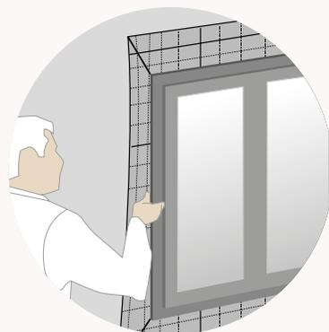
3. **Aplicar presión con la mano** para garantizar una adherencia óptima de la membrana a la masilla de cola.
