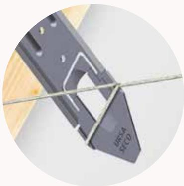
1. **Fijar la suspensión** en el lado de la viga con la ayuda de dos tornillos. Alinear las suspensiones con ayuda de un cordel.
