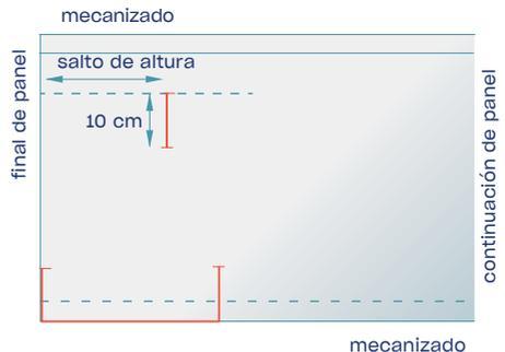
➤ Desde la paralela del Salto hacia la derecha marcaremos el alto de la pieza+2. Y después se trazará una línea paralela al alto hacia abajo, a una distancia de 10 cm.
