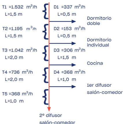
En el caso del apartamento de Alicante vamos a limitar la altura del conducto a 15 cm ya que queremos poner el falso techo con un plenum de menos de 22 cm. Si completamos todos los datos del anterior esquema en la plantilla de cálculo URSA AIR, obtendremos el resultado que se observa en la siguiente imagen.
