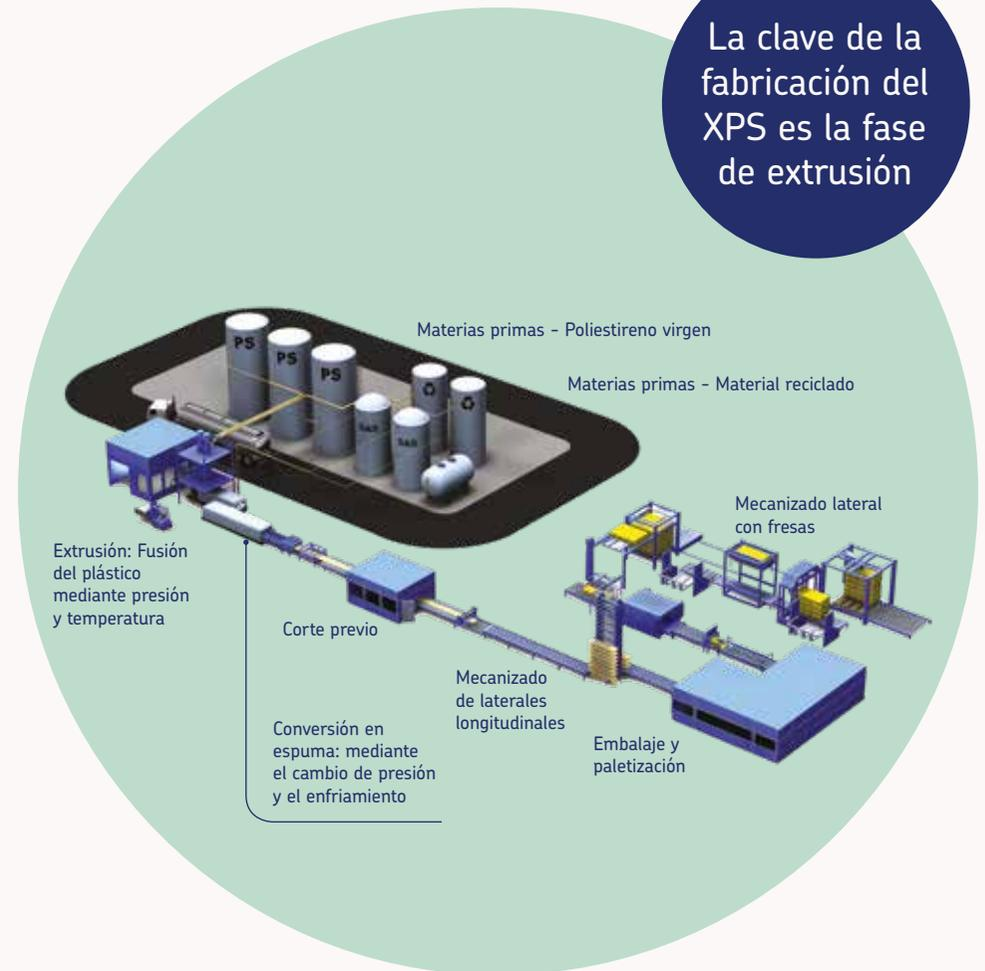
En la salida de la extrusora, el cambio a presión atmosférica de manera repentina, provoca la gasificación del agente espumante, que al intentar liberarse permite la espumación de la masa, y además absorbe la temperatura del poliestireno, enfriándolo y por tanto solidificándolo. La sección de la salida de la extrusora determina la sección de la banda continua de poliestireno extruido que por ella sale.
