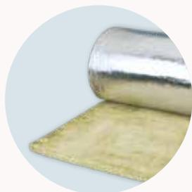
Manta de lana mineral con tecnología InCare para el aislamiento de conductos metálicos de climatización por el exterior, conforme a la norma UNE EN 14303. Permite trabajar a temperaturas de aire de circulación de hasta 120°C.
