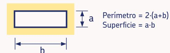
$$\Delta L[\text{dB}] = 1,05 \cdot \alpha^{1,4} \cdot \frac{\text{Perímetro [m]}}{\text{Superficie [m]}}$$
