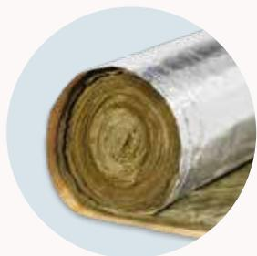
Manta de lana mineral con tecnología InCare para el aislamiento térmico de conductos metálicos de climatización por el exterior, conforme a la norma UNE EN 14303. Permite trabajar a temperaturas de aire de circulación de hasta 120°C.
