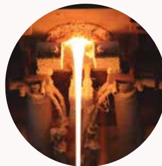
Horno de fusión donde toda la materia (arena de sílice, feldespatos o dolomita y vidrio reciclado) se funde a altísimas temperaturas, superiores a 1.300 grados centígrados.
