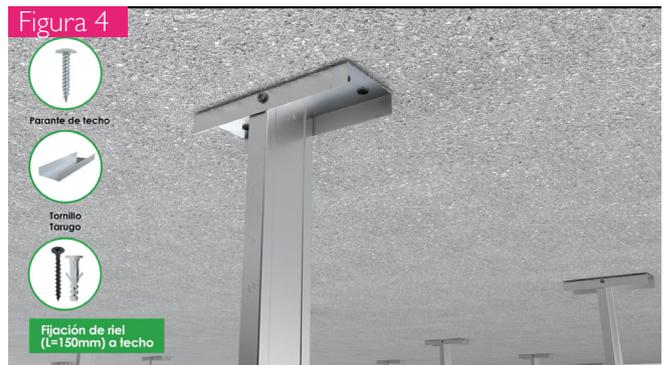
Las fijaciones del riel de conexión a la losa deben estar acorde al sustrato. Para placas Superboard 6 mm, instale las velas rígidas a una distancia máxima de 81.3 cm entre sí siguiendo el eje de las vigas principales y a una distancia máxima de 122 cm en el otro sentido perpendicular a las vigas principales. Verifique la verticalidad de los elementos. **Fig. 5**
