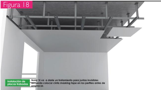
Se deberá dejar una separación de 1 cm, entre las placas y los muros perimetrales del recinto para evitar la transmisión de esfuerzos de los muros al cielo raso. Nunca deberán fijarse las placas Superboard a los rieles perimetrales. Fig.19
