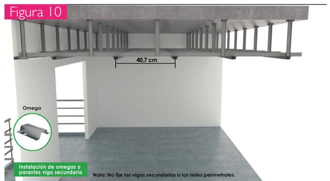
La primera viga secundaria deberá quedar a una distancia de 10 cm del extremo del muro. Nunca se deberán fijar las vigas secundarias a los rieles perimetrales con ningún tipo de fijación. Fig. 11
