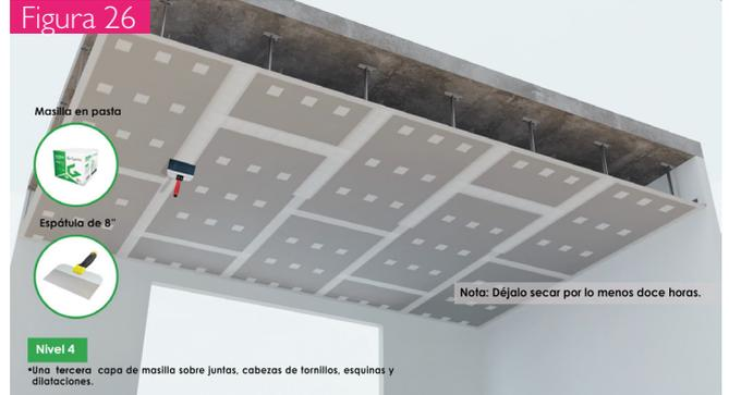
**Nota:** Para obtener un óptimo acabado de la superficie de las placas Superboard, se requiere un nivel de acabado 5 que implica un masillado general de toda la superficie. Para un nivel de acabado 4, es necesario la aplicación de texturas gruesas.
