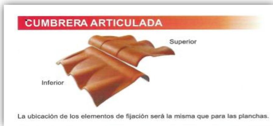
Compuesta por dos piezas: superior e inferior articulada a fin de poder adaptarse a cualquier inclinación de techo. Están fabricadas con una mezcla homogénea de cemento, fibras, agua, materiales y otros agregados, moldeada a mano, además, cuentan con un recubrimiento de pintura de gran calidad para obtener la máxima durabilidad y presentación.
