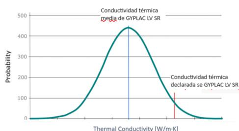
La resistencia térmica de los productos aislantes se define como el cociente del espesor y su conductividad térmica.
