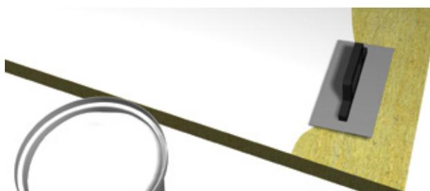
Nanесите горе наведену дебљину мокрог филма (коначна дебљина сувог филма  $\geq 0,7\text{ mm}$ ) и узмите у обзир време сушења. Ако плоће минералне вуне нису претходно премазане, током уградње осигурјите да је финална дебљина сувог филма на површини буде  $\geq 0,7\text{ mm}$ .
