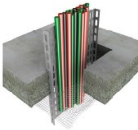
2. Para aplicaciones horizontales (únicamente) instale una estructura de soporte (Ej: malla de acero galvanizado) en la parte inferior de la losa.
