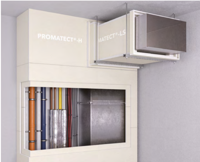
Abbildung 3: ABP P-3082304/14-MPA BS: Anschluss einer PROMATECT®-LS-Bekleidung für Stahlblechkanäle L 90 an eine PROMATECT®-H-Schachtwand F 90 (Promat-Konstruktion 478 und 450.41)
