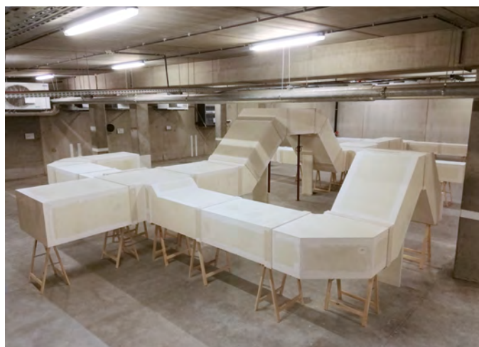
Messung von Druckverlusten an einem Promat-Kanalsystem
