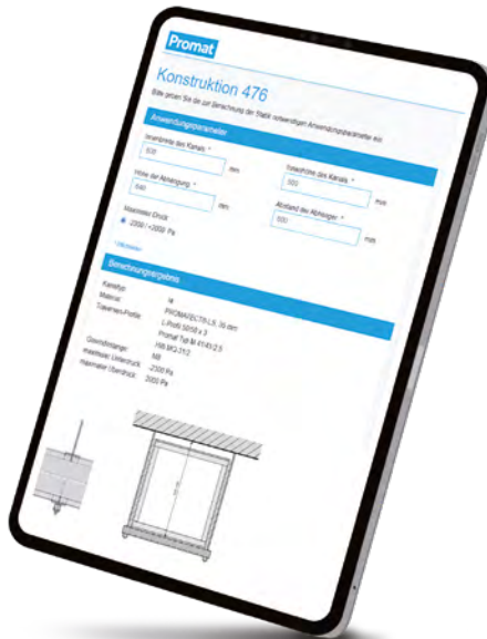
Beispielhaftes Bemessungsergebnis mit dem Promat-Tragschienen- und Gewindestäbekonfigurator
