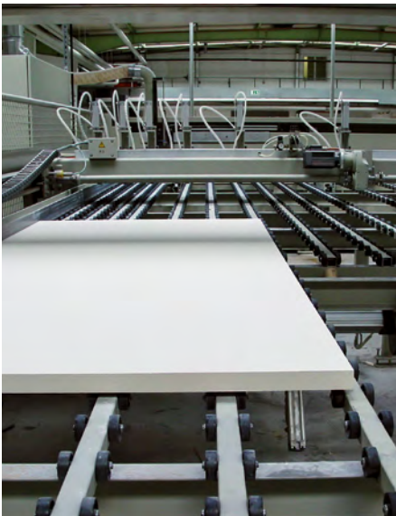
Plattenaufteilanlage für den Zuschnitt von Promat-Brandschutzbauplatten
