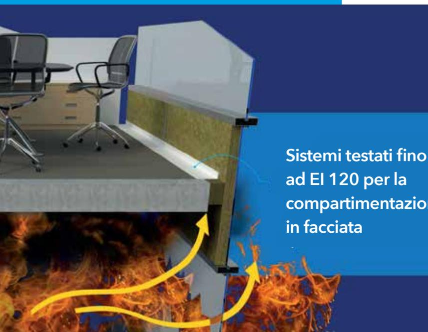
Sistemi testati fino ad EI 120 per la compartimentazione in facciata
