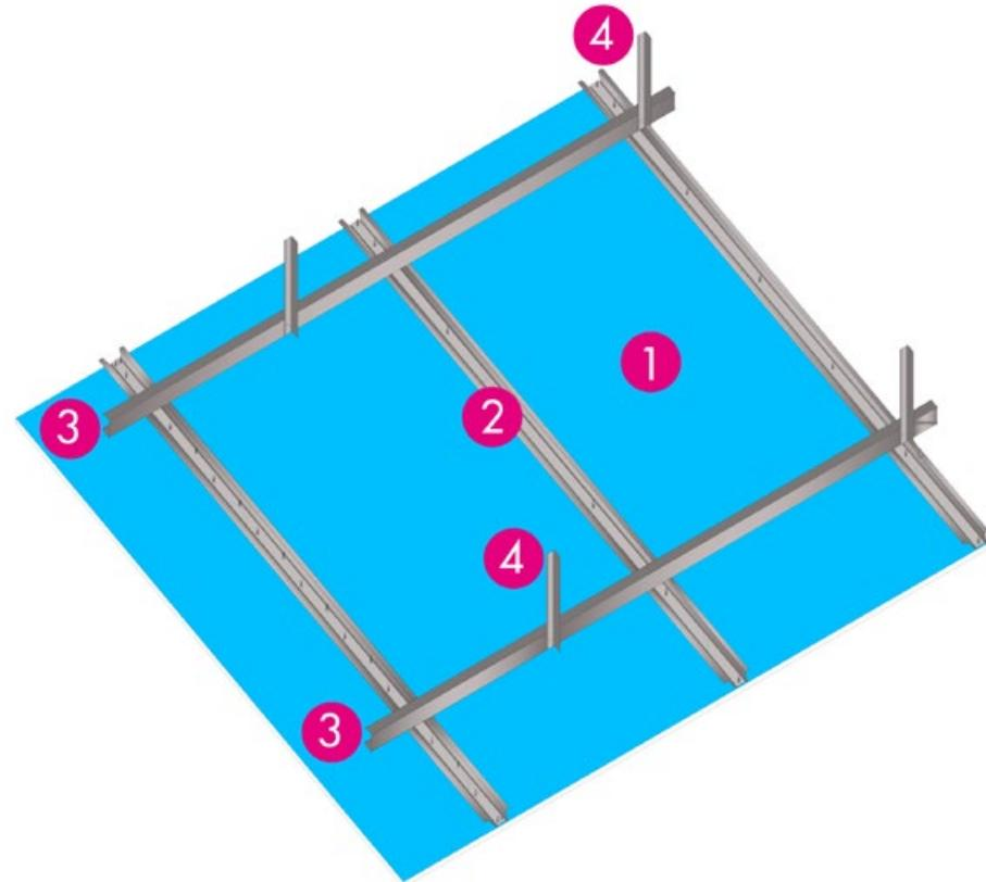
Las placas se fijan en los cielos a las estructuras metálicas que conforman el bastidor, siempre perpendicular a estas y fijadas de la misma manera que las placas de yeso Gyplac®, con tornillo tipo drywall N° 6x1”.
