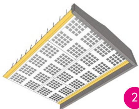
Las placas deben ir de forma trabada o al menos traslapadas **60 cm**, el equivalente a dos modulaciones.
