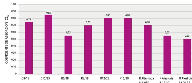
Todos los ensayos acústicos de los sistemas Gyplac® Exsound han sido realizados con plenum 600 mm y lana de fibra de vidrio de 3.1" (80 mm) de espesor.
