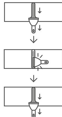
Aplicar la cinta de papel microporoso presionándola con una espátula. Retirar el excedente y cuando la primera capa esté seca, aplicar una nueva capa, tapando la cinta aplicada.
