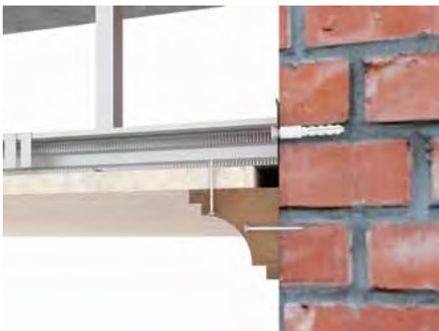
Pengikatan sekrup penyebab keretakan
