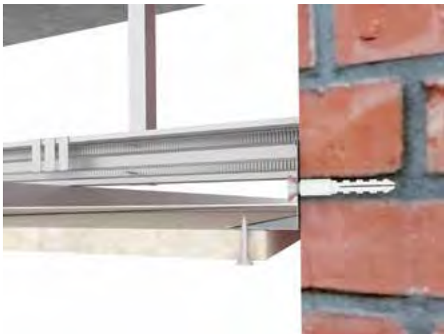
Pengikatan sekrup penyebab keretakan
