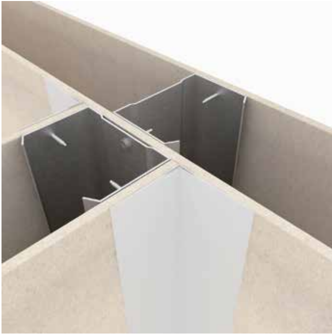
Perspektif pertemuan dinding bagian dalam / bentuk - T
