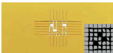
EN ISO Klasifikac.: 3/ASTM Klasifikac.: 2 B Premaz se lušči vzdolž robov rezov delno ali v celoti v velikih trakovih in/ali se je odluščil deloma ali v celoti na različnih mestih kvadratov. Območje križnega reza je prizadeto bistveno več kot 15 %, vendar ne bistveno več kot 35 %.
