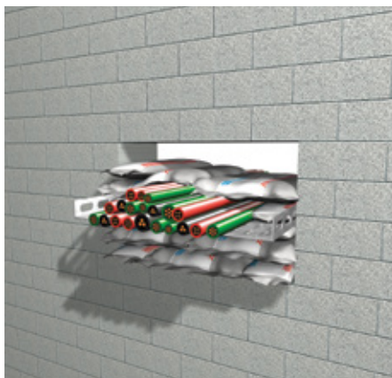
4. Prekrijte kablove i/ili cevi protivpožarnim jastucima.
