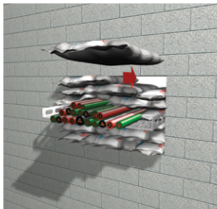
5. Zatvorite otvor protivpožarnim jastucima koje treba postavljati na način na koji se postavljaju cigle, npr. sa smaknutim vertikalnim spojevima, a prilikom postavljanja jastuke treba što čvršće sabiti unutar otvora. Važno je napomenuti da unutar otvora ili oko instalacija nisu dozvoljene praznine.
