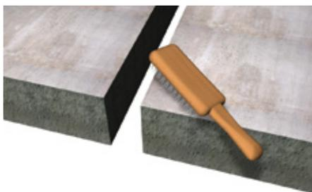
1. Očistite otvor i po potrebi ga navlažite vodom
