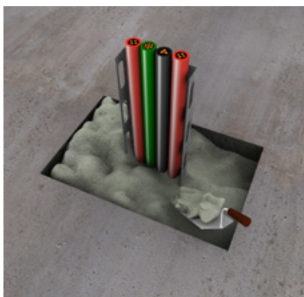
5. Останалия отвор запълнете с PROMASTOP®-М. Имайте предвид, че мазилката се поставя в преминаване с по-големи размери, което изисква по-големи количества, за да се достигне необходимата дебелина или височина.
