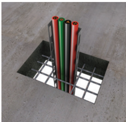
2. За изграждане на запълвачи уплътнения в подове, монтирайте шпилки с дължина 100 mm. Тези шпилки трябва да се поставят през 300 mm централно в запълващото уплътнение от мазилка, но минимум по една шпилка във всяка страна. Забиват се в пода на дълбочина 50 mm и се покриват с 50 mm PROMASTOP®-М. При стенен монтаж не се изискват шпилки.
