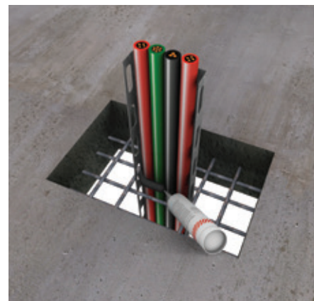
3. Върху кабели и кабелни снопове нанесете PROMASEAL®-AG.
