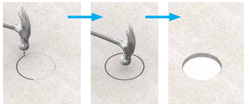
Wykonywanie otworów z użyciem gwoźdźca i młotka
