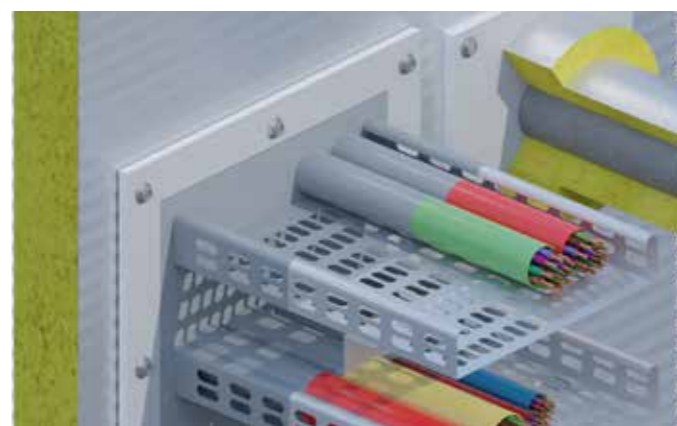
Detal F Zabezpieczenie kabli za pomocą masy
