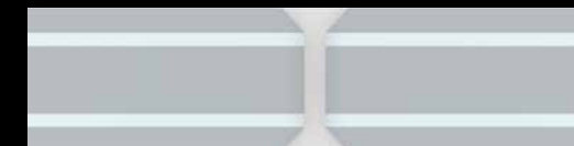
Promat® SYSTEMGLAS 30 - type 1 Rf 1/2h - Epaisseur totale: 17 mm
