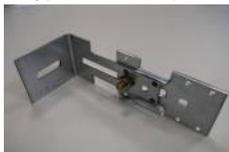
Les chevrons verticaux sont fixés sur le mur porteur à l'aide des équerres réglables. Ces équerres réglables permettent de palier aux irrégularités du mur porteur, d'intégrer une isolation par l'extérieure et de réaliser une lame d'air de 20 mm minimum entre l'isolant et le face arrière d'une plaque.
