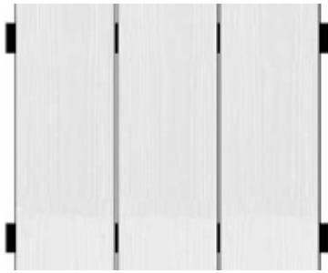
Profil joint filant (pour joint fermé)
