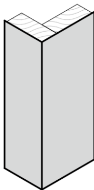
Protection de l'angle extérieur
