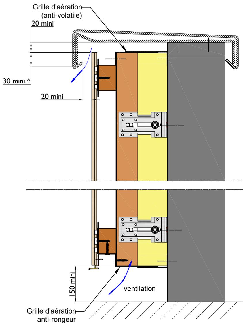
\* Augmenter le recouvrement à 60 mm pour des hauteurs égales ou supérieures à 18 m
