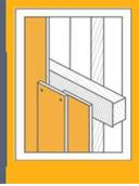
Le débord de la lame de façade Cedral Lap au-dessus de la première latte de support ou au-dessus de la latte de support supérieure ne peut excéder 100 mm.
