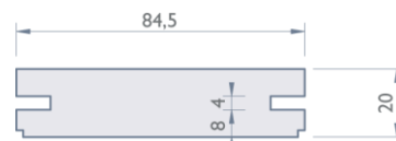
Flächendiele , Nutzfläche 0,26 m 2 pro Diele Breite 84,5 mm, Länge 3.150 mm, Nut beidseitig
