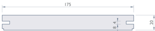
Flächendiele , Nutzfläche 0,55 m 2 pro Diele Breite 175 mm, Länge 3.150 mm, Nut beidseitig
