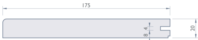
Abschlussdiele , Nutzfläche 0,55 m 2 pro Diele Breite 175 mm, Länge 3.150 mm, Nut einseitig, Kante gerundet
