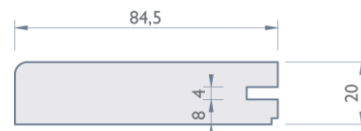
Abschlussdiele , Nutzfläche 0,26 m 2 pro Diele Breite 84,5 mm, Länge 3.150 mm, Nut einseitig, Kante gerundet
